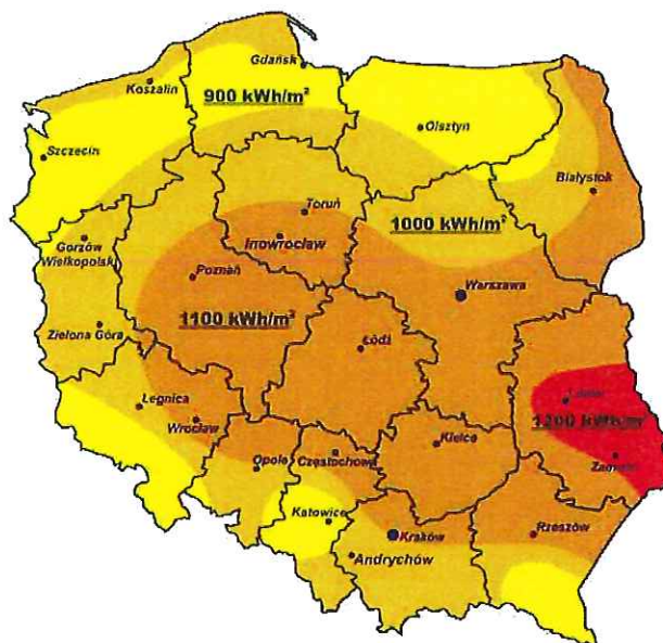
Rysunek 3. Rejonizacja średniorocznych sum promieniowania słonecznego całkowitego padającego na jednostkę powierzchni poziomej w kWh/m 2 /rok.
